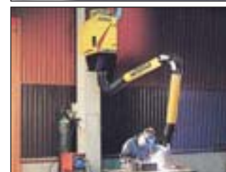
Braccio KUA montato flangiato sotto ad un filtro EF
