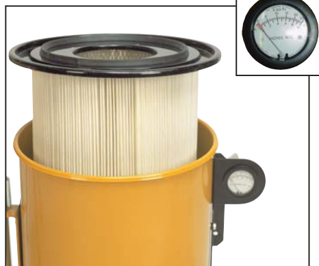
Stadio 2: Togliete l'elemento filtrante e cambiatelo con uno nuovo quando l'indicatore di pressione raggiunge la massima caduta di pressione.
