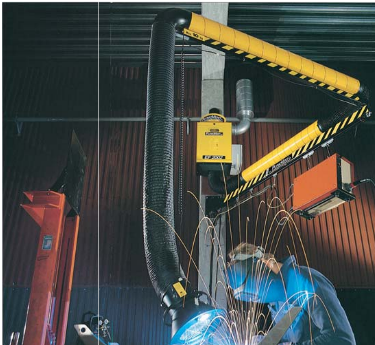
A lato : bandiera snodata Plymoth con filtro EF-2002/AL, elettroventilatore e silenziatore.
